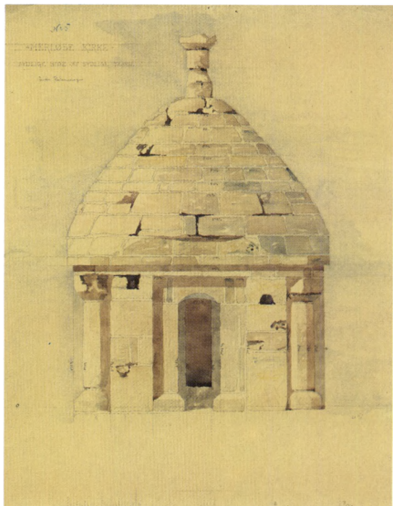
Fig. 18a-b. Detaljer af søndre tårntop (s. 2962). 1:50. a. Opstalt af sydside. b. Tværsnit set mod vest. Farvelagte opmålinger ved Harald Harpoth 1893. - Details of the top of the south tower. a. Elevation of the south side. b. Cross-section to the west.
